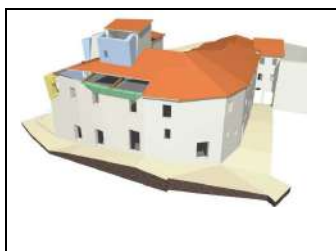
Fig.67 Aggregato urbano : presenza di irregolarità in pianta-elevazione ed individuazione delle pareti esposte a meccanismi locali 1
