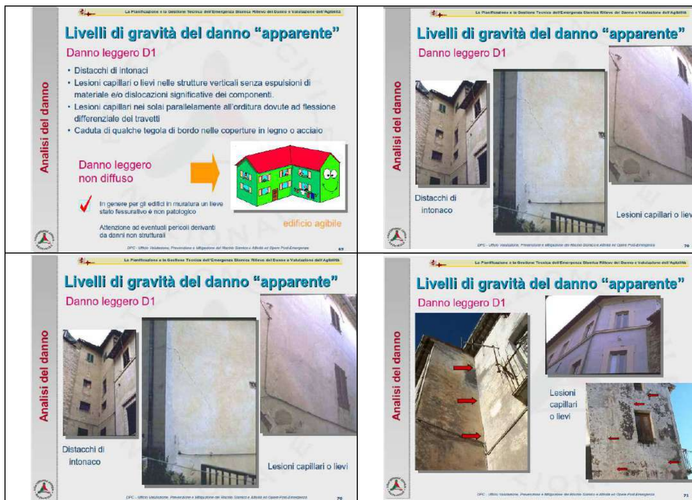
Fig. 56 – livello di danno D1
