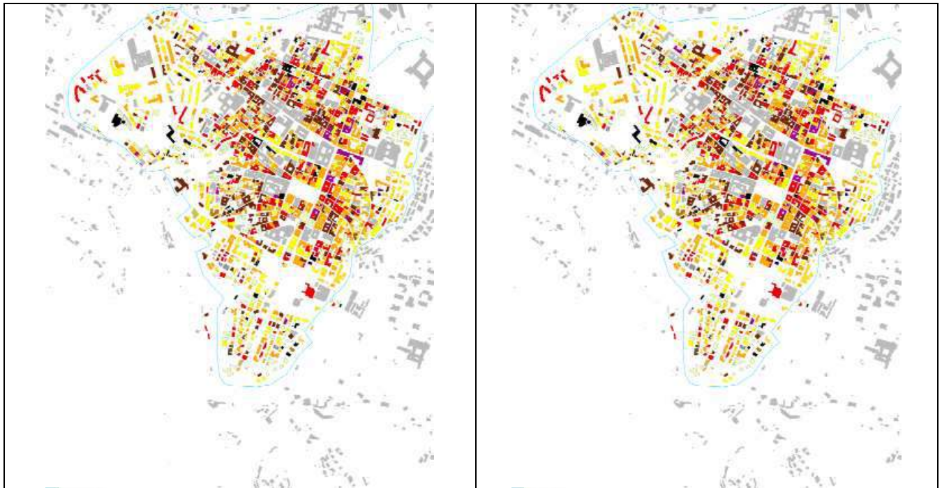
Fig. n.25 - Centro storico L'Aquila : danno alle strutture verticali
