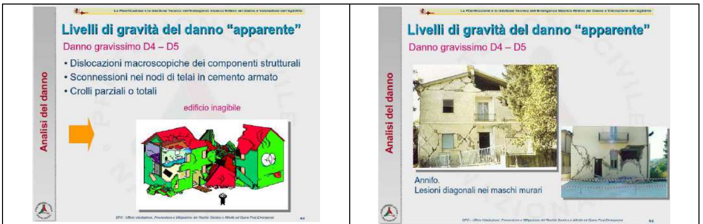
Fig.59 – livelli di danno D4 e D5
